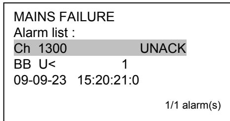
Кнопка ESC используется для выхода из списка неисправностей.
