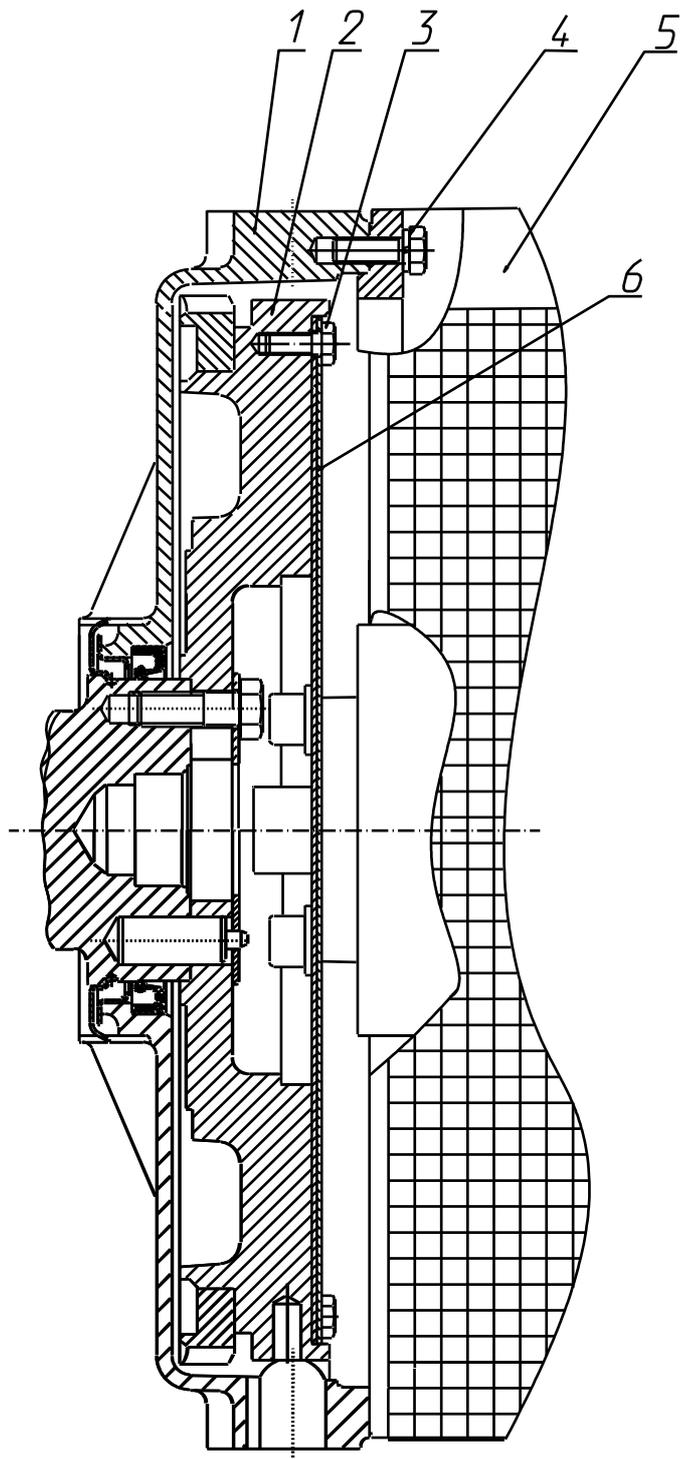
**Рис. 5. Соединительная дисковая муфта**
