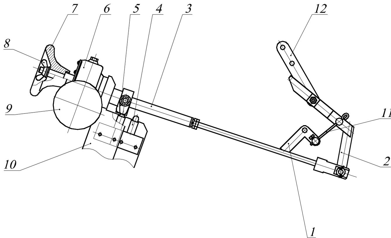
Рис. 3 Механизм управления регулятором
